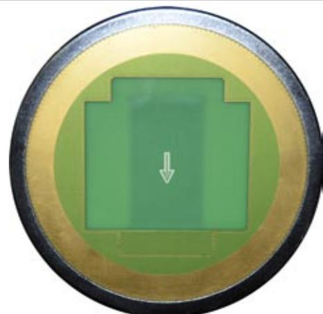
Bild 4 – Unterseite B-Feldprobe
