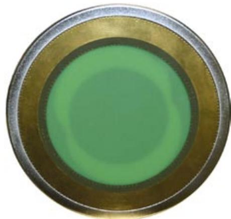
Bild 6 – Unterseite E-Feldprobe
